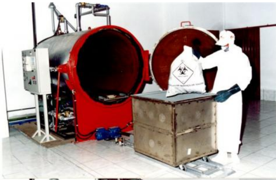
Figura 10.8 -Autoclave empresa TUCANO Obras e Serviços Ltda
