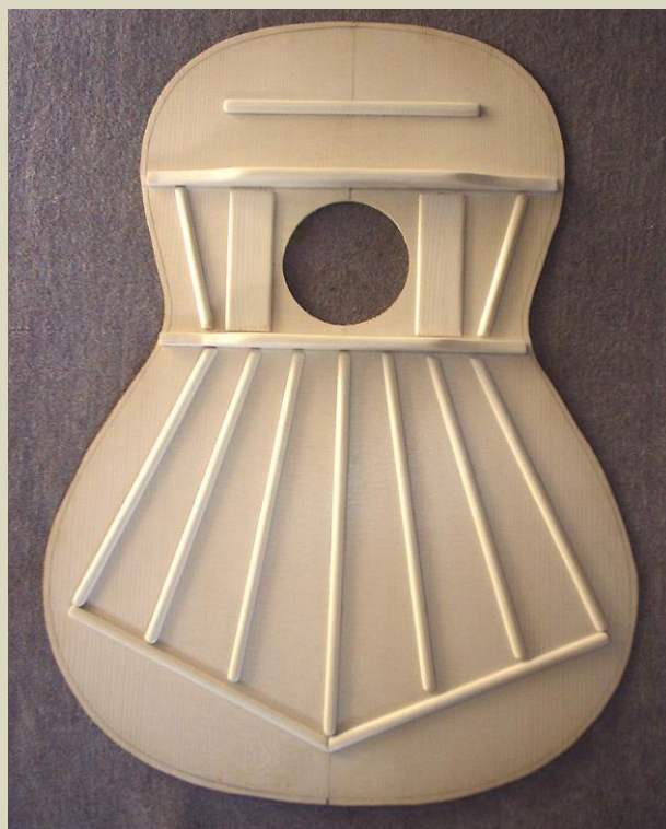
Imagem 04. Visão interna do Tampo de um Violão Modelo Torres (Jatobá,2022)
